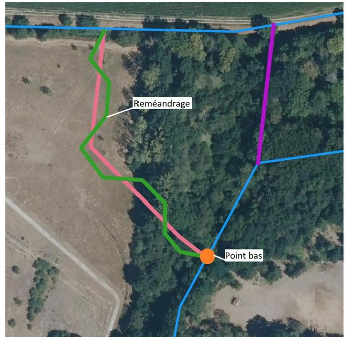
Tracé actuel (en rose) reméandrage programmé (en vert) (schéma de principe)
